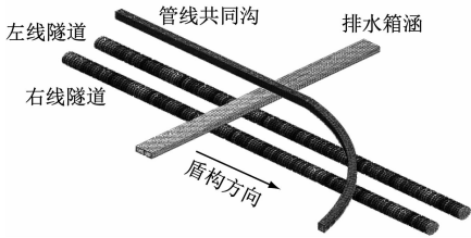
图 5 隧道、箱涵、管沟仿真模型
