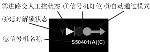
图 1 192 基线 ATS 界面的信号机显示
