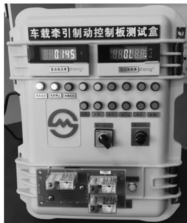
图 3 车载牵引制动故障控制板测试装置实物图
