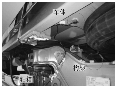
图2 转向架区域振动测点布置场景
