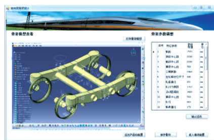
b) 转向架骨架设计
