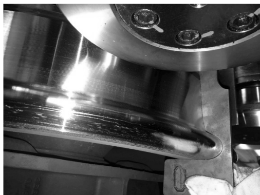
图16 奇数轮缘厚度等级踏面镟修后模板检查现场
