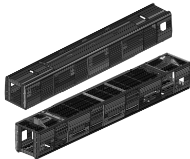
图2 车体有限元模型
